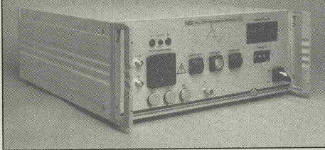
Bild 6. Generator zur Erzeugung des Millisekunden-Impulses in Bild 5.
